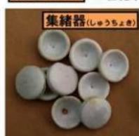
集織器は、生糸を作る操糸機の磁器製部品です。鍋で煮た繭から糸を繰り出して中央の細い穴を通って燃りがかけられ糸となります。
