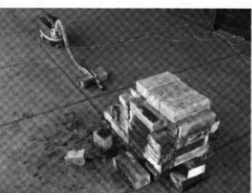
写真19 耐熱レンガの炉と送風機能付き掃除機
