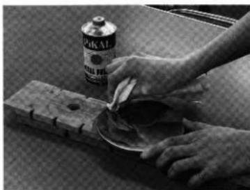
写真29 金属研磨材による鏡面研磨
