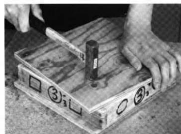
写真10 鏡面側鋳型の砂を固める
