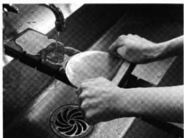
写真28 紙ヤスリによる鏡面研磨
