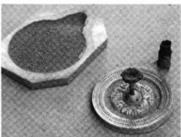
写真25 表面が剥離した鏡面側鋳型と鋳上がった鏡
