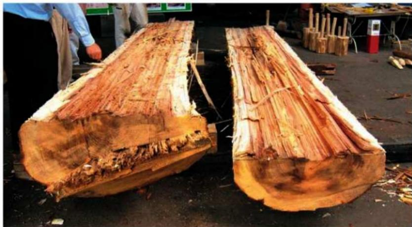
二つに割れた丸太（左の材を使用して復元立柱を製作）
