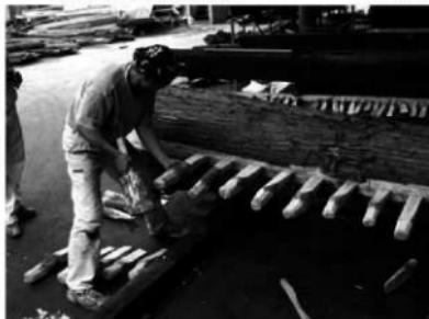
丸太に木楔の先端を打ち込む
