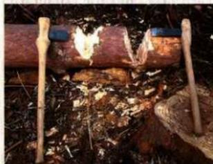
写真2 鉄斧と石斧での木材切断実験
