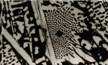
Photo.1 鉄塊系遺物の顕微鏡組織
