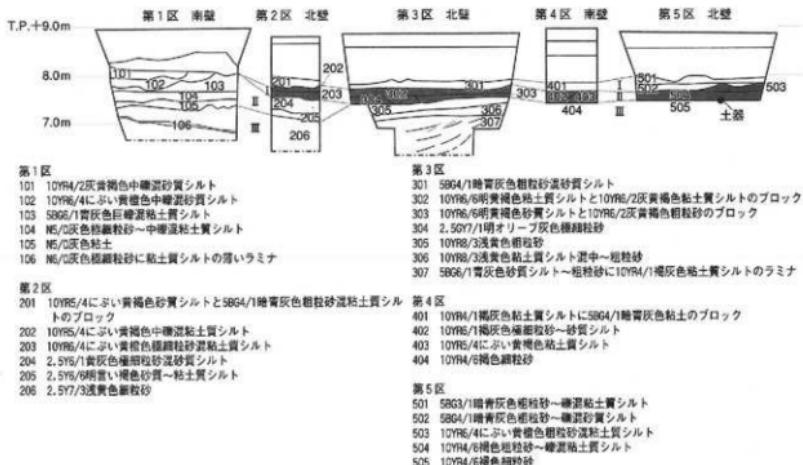
第29図 地層断面図（S=1/100）
