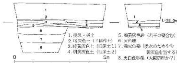
第32図 樽井地区土層断面図
