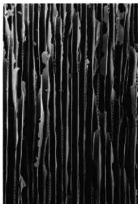
4b モミ属(接線断面) No27 bar : 0.5mm
