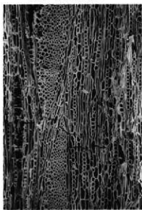
6b クスギ節(接線断面) No27 bar : 0.5mm
