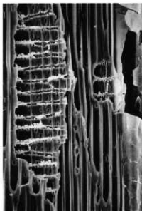
4c モミ属(放射断面) No27 bar : 0.1mm
