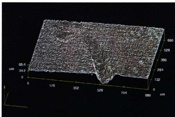
第617図 レーザー顕微鏡による鏡面の整痕の観察
