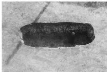
a. 1号縮穴の全景
