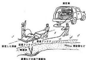
図-1 地下レーダー測定方法
