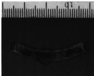
写真7 天引狐崎遺跡出土銅銅片の蛍光X線測定部分
