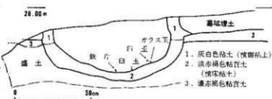
第9図 主体部断面図（東西溝北壁）
