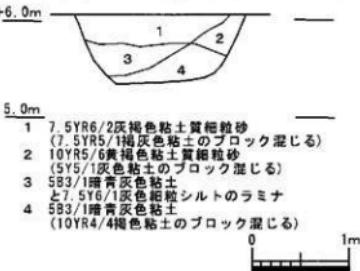
第7図 S D 301断面図 (S=1/50)
