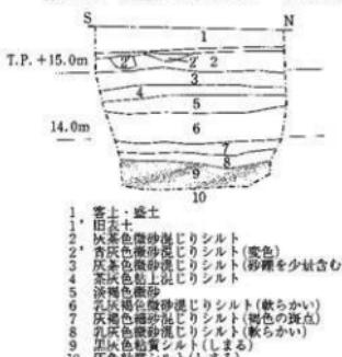
第28図 浄化槽部分断面図(S=1/80)
