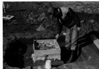
8. サンプルと枠の隅を発泡スチロールで固定する
