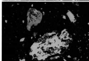
第3図 増輪片(B-2)中の変成岩片の偏光顕微鏡写真(上:単ニコル,下:直交ニコル)。この変成岩片は主に石英と緑閃石からなる。
