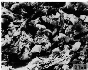
n\text{Al}_2\text{O}_3 \cdot m\text{SiO}_2 \cdot l\text{H}_2\text{O} + \text{glass} ×5000
