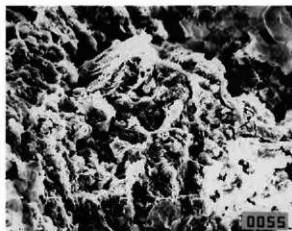
n\text{Al}_2\text{O}_3 \cdot m\text{SiO}_2 \cdot l\text{H}_2\text{O} + \text{glass} ×1500
