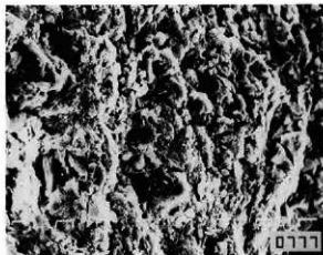
n\text{Al}_2\text{O}_3 \cdot m\text{SiO}_2 \cdot l\text{H}_2\text{O} + \text{glass} ×1500
