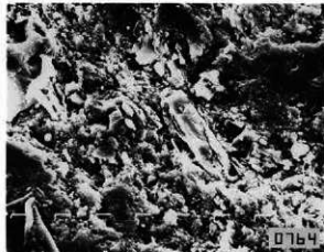
n\text{Al}_2\text{O}_3 \cdot m\text{SiO}_2 \cdot l\text{H}_2\text{O} + \text{glass} ×1500
