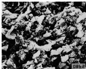
n\text{Al}_2\text{O}_3 \cdot m\text{SiO}_2 \cdot l\text{H}_2\text{O} + \text{glass} ×5000
