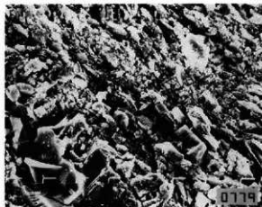
n\text{Al}_2\text{O}_3 \cdot m\text{SiO}_2 \cdot l\text{H}_2\text{O} + \text{glass} ×1500
