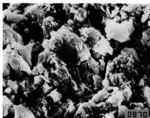
n\text{Al}_2\text{O}_3 \cdot m\text{SiO}_2 \cdot l\text{H}_2\text{O} + \text{glass} ×5000
