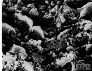
n\text{Al}_2\text{O}_3 \cdot m\text{SiO}_2 \cdot l\text{H}_2\text{O} + \text{glass} ×5000
