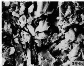
n\text{Al}_2\text{O}_3 \cdot m\text{SiO}_2 \cdot l\text{H}_2\text{O} + \text{glass} ×5000
