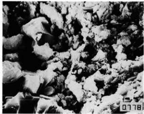
n\text{Al}_2\text{O}_3 \cdot m\text{SiO}_2 \cdot l\text{H}_2\text{O} + \text{glass} ×5000
