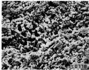
n\text{Al}_2\text{O}_3 \cdot m\text{SiO}_2 \cdot l\text{H}_2\text{O} + \text{glass} ×1500
