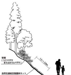
図 46 墳丘裾部護岸イメージ図
