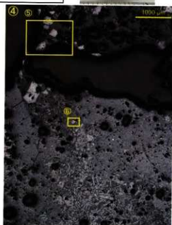
Photo.3 羽口・流出孔～溝滓の顕微鏡組織
