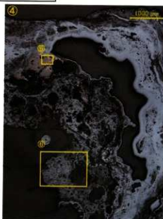
Photo.7 流出溝滓・炉内滓（含鉄）の顕微鏡組織
