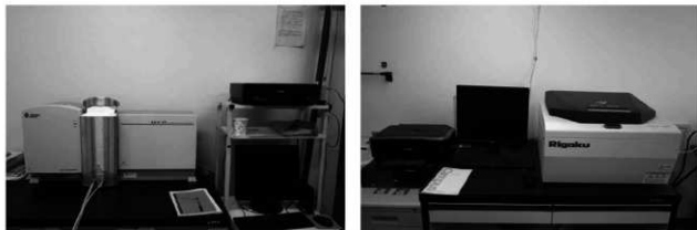
第34図 分析装置1 (左) レーザー解析散乱型粒度分析装置 (ベックマン・コールター社 LS13 320) (右) 卓上型エネルギー分散蛍光 X 線分析装置 (リガク社 EDXL300)
