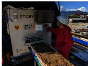
図4 地層抜き取り試料の4K画像・X線画像撮影作業 （2023年・南大原遺跡）
