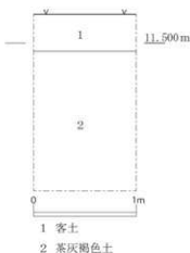
第18図 土層柱状図 (S=1/40)
