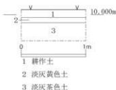
第14図 土層柱状図 (S=1/40)
