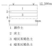
第10図 土層柱状図 (S=1/20)
