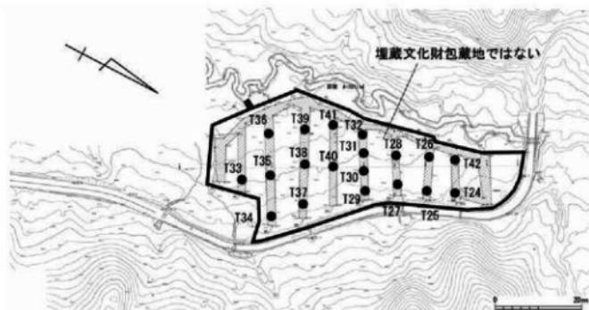
第4図 一般国道183号鍾掛峠道路改良事業計画地（残土処分場D箇所）試掘坑位置図（1:1,000）
