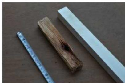
写4.3.1 木煉瓦 左：在来木製 右：補足セラミック製(制水井上屋・接合井)
