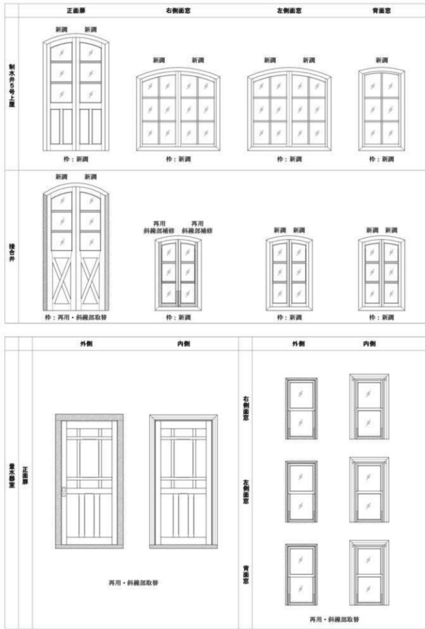
図4.3.2 木部補修図2（制水井上屋5号、接合井、量水器室）
