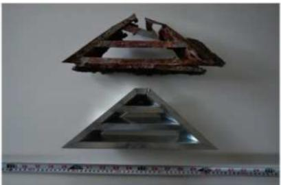
写4.2.45 制水井5号上屋ドーマー窓ガラリ(破損及び補足材)
