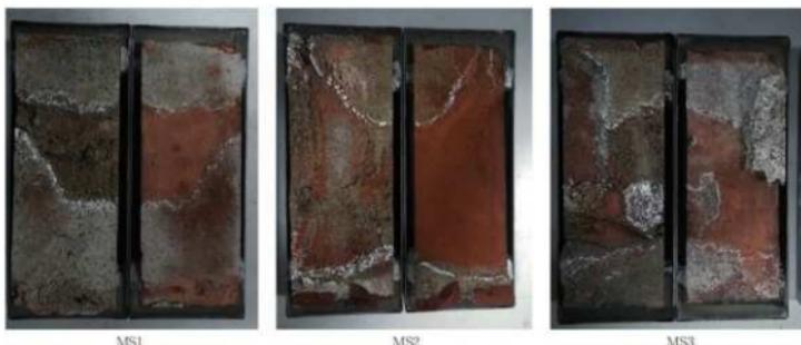
写3.4.4 煉瓦組積体目地せん断強度における破壊形態と目地充填状況
