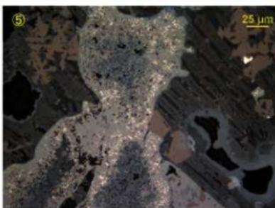
第 78 図 鉄塊 EPMA 調査結果・含鉄鉄滓の顕微鏡写真
