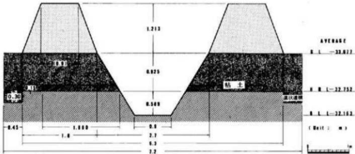
第34図 野火止用水断面復元模式図 (1/60)
