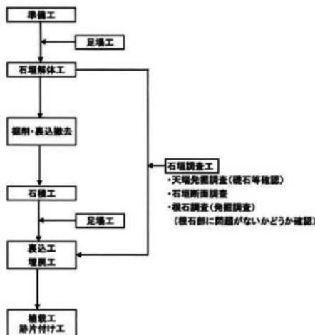
図 II-4 工事・調査フロー (1工区)
