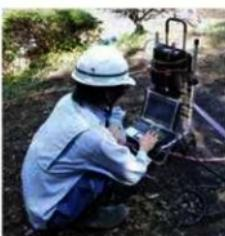
地中レーダー探査では、電磁波を地中に照射し空洞や埋設物に由来する反射波形（異常反応）を捉えることで地中の様子を探ります。調査地の状況に応じて探査機材の大きさなどを選択するため、事前調査が欠かせません。また、深くなればなるほど反応を細かく捉えることは難しく、現状では地下2～3mまでが限度です。さまざまな波形が組み合わさっているため（図2）、データの解析には十分な経験が必要です。
