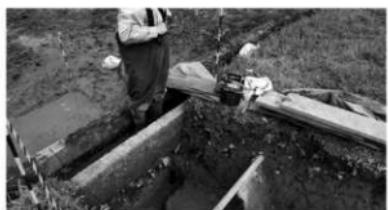
写真4 年代測定のための杭切片採取 (T-1)
