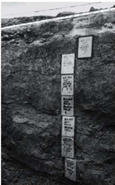
図123 運河SD1901Aにおける地質切取試料の採取風景
