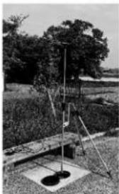
図4 ネットワーク型RTK-GNSS
