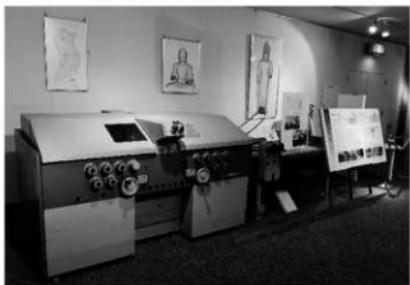
図1 奈良文化財研究所が導入した解析図化機
