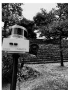
図11 ハンドヘルド型LiDAR
