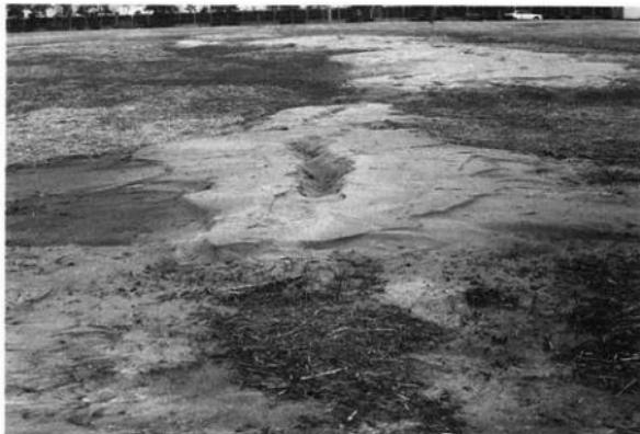
写真1 兵庫県南部地震によって流出した噴砂
