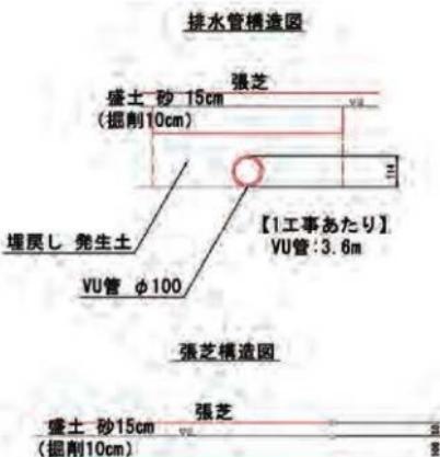
図12 芝生化・排水施設改修構造図 (1/20)
