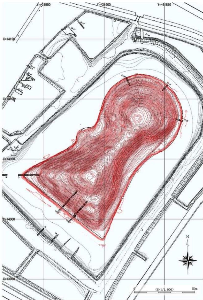
図8 既存測量図との比較 (黒：埼玉県教育委員会提供図面／赤：0.2m Contour)
