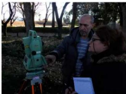
写真11 TSを用いた基準点測量
