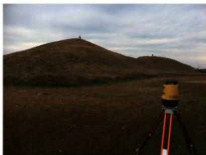
写真6 LNを用いた点群測量
