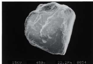
No.3 加勢蛇川(川砂)(v-shaped fractures)
