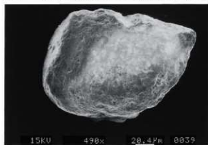
No.2 北条町(飛砂)(bulbous edge,v-shaped scars)
