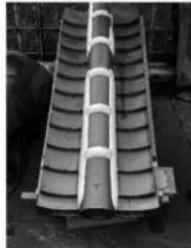
漆喰が付着した丸瓦と、丸瓦側面に施工されていたと考えられる漆喰片があり、丸瓦の漆喰施工範囲や目地漆喰断面形状の参考史料として施工時の検討に用いた。
