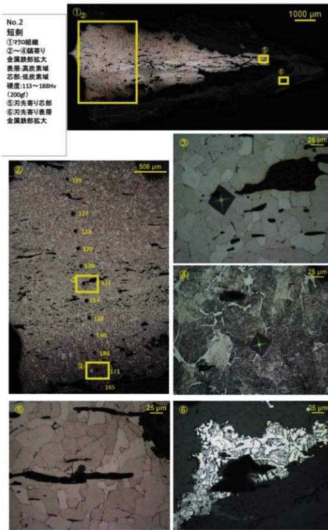
図18. No. 2短剣の断面顕微鏡組織
