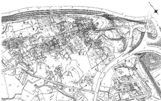
第33図 道橋内ボーリング調査位置 (B-1~B-4) 平成16年度実施 水位は16.11~17.3で観測
