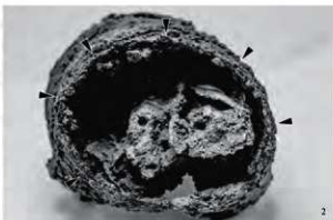
鉄線の屈曲点：▲の位置で屈曲が確認できる。
