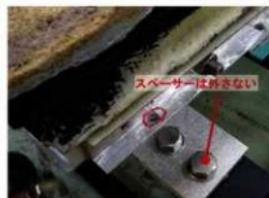
15. 【手順4-④】 左側壁取外し作業注意点
