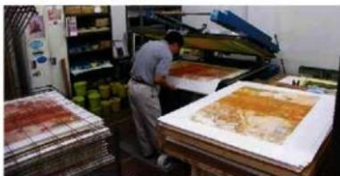
4. 【工程 10-(2)】作業工程④: 製版・印刷
