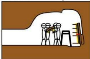
取出し作業 ※壁面の上段・中段・下段の順で取り外す
