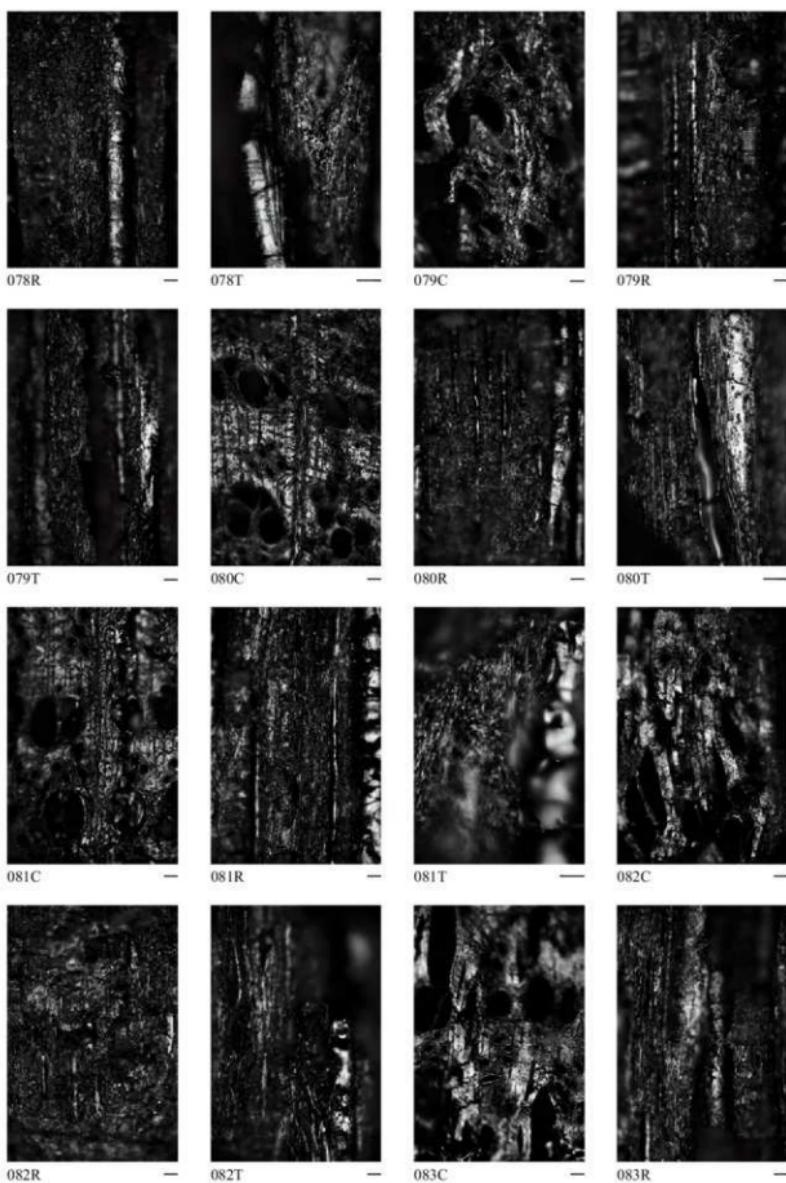
図版 85 合戦原遺跡出土炭化材 (16) C: 横断面、R: 放射断面、T: 接線断面、スケールは 0.1mm
