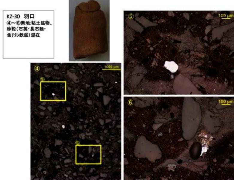
図版69 製鉄関連遺物の顕微鏡組織(15)
