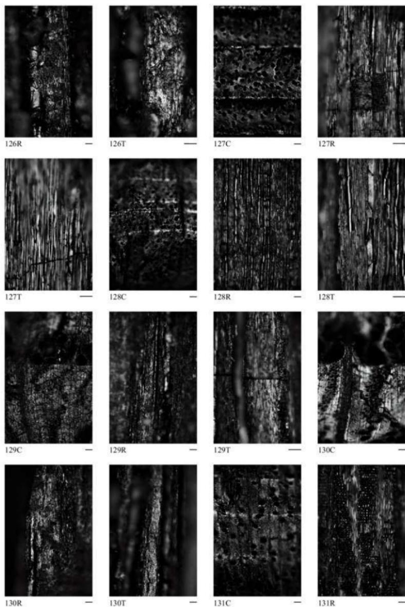
図版 94 合戦原遺跡出土炭化材 (25) C: 横断面、R: 放射断面、T: 接線断面、スケールは 0.1mm
