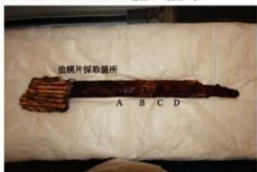
図 9-1. No. 1769腰刀のXRF箇所 (A~D)
