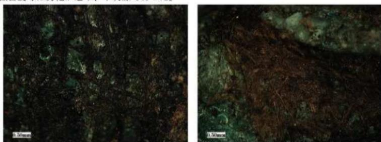
図 51. No. 9324簡状銅製品の微小部観察画像（左図：A箇所、右図：B箇所）
