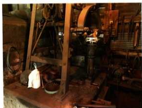
写真2 ベルトハンマー周辺
