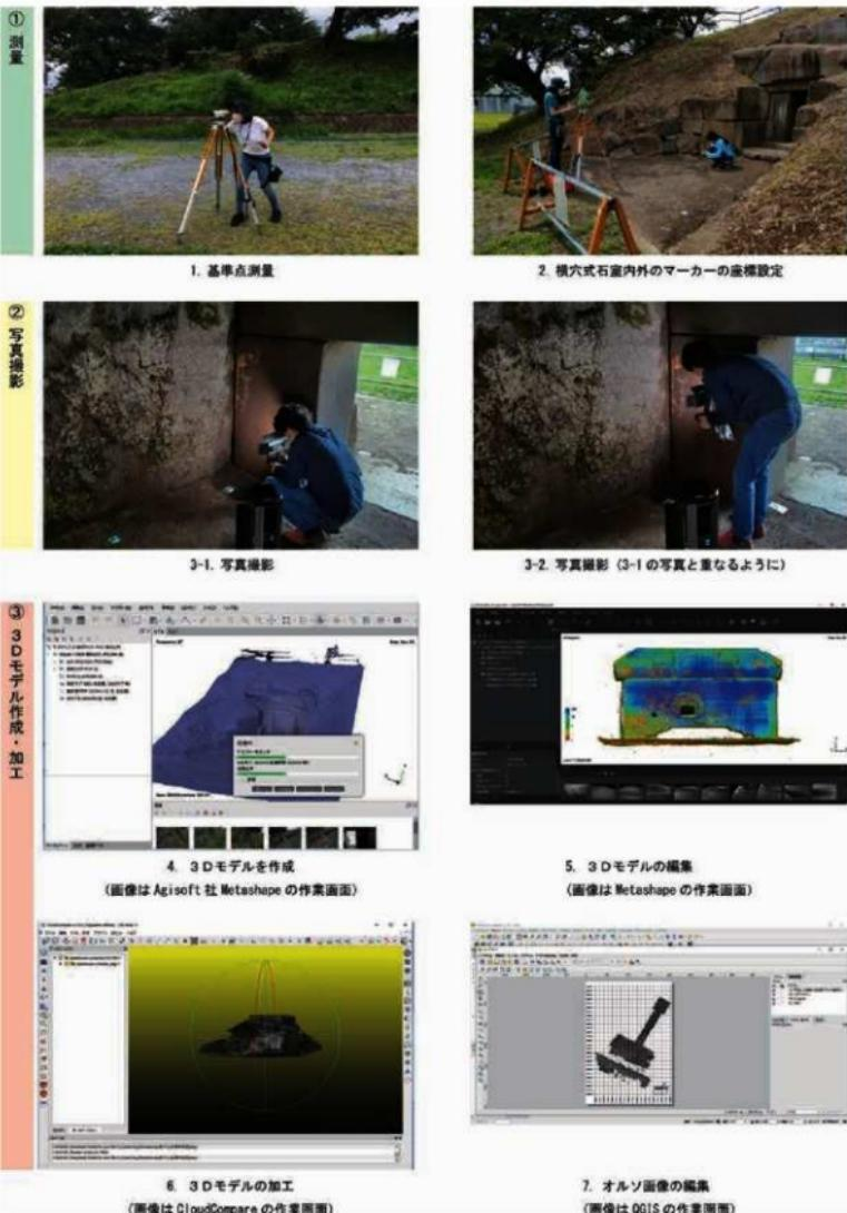
Fig.4 SfM/MVS による 3D モデル作成作業の流れ
