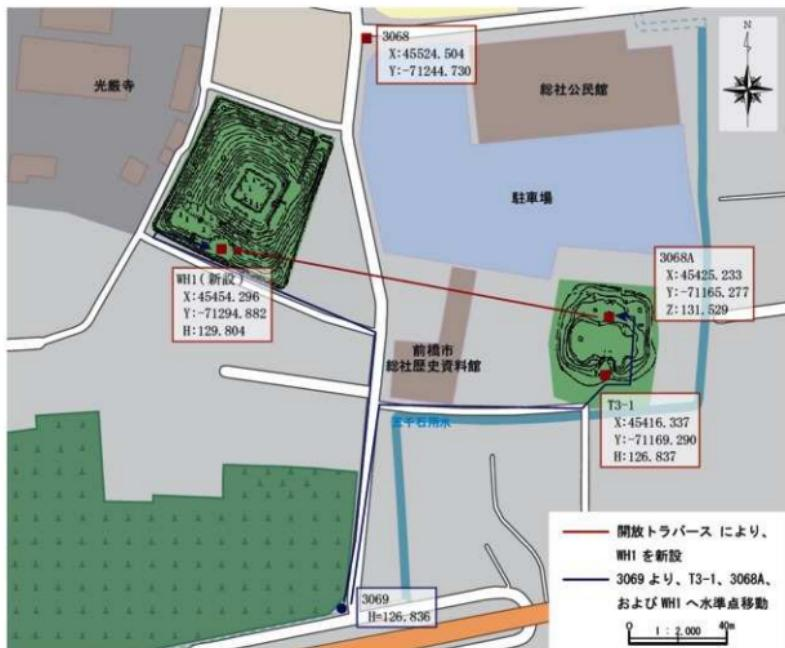
Fig.3 宝塔山古墳・蛇穴山古墳周辺の公共基準点と測量作業図
