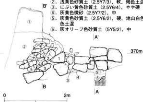
第64図 石垣崩壊箇所 平・立面図 (S=1/60)
