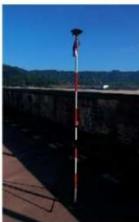
図-1 RTK-GNSS受信機
