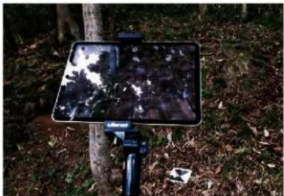
図5 MetascanによるLiDAR計測
