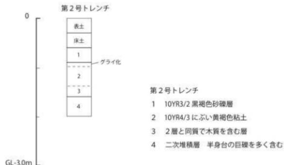
第3図 第2号トレンチの土層柱状図
