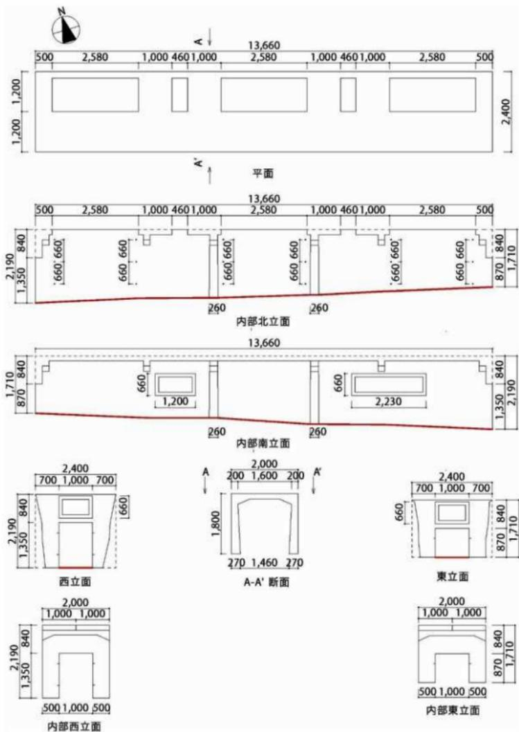
図41. 上富良野村分会小銃射撃場監的塹の実測図
