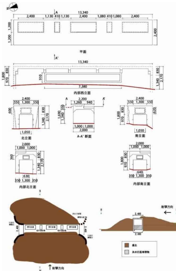
図21. 山部村分会小銃射撃場監の壁の平面・立面・断面図
