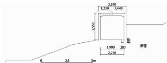
図8. 富良野町分会小銃射撃場監的塹の断面図
